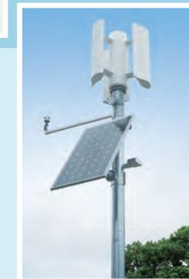
東日本大震災直後の福島県における原発事故を契機に、再生可能エネルギーの必要性が高まる中、長年風力発電の研究を行っている琉球大学工学部と株式会社平仲は、強風時を考慮した小型垂直軸型風力発電機の最適運転を課題に研究開発を進めています。この開発中の発電機は、プロペラ式の風力発電と比べて騒音の低減が見込まれ、また、太陽光発電も同時に設置することで、風況が良ければ24時間発電可能な独立型の風力・太陽光ハイブリットシステムとして機能することが期待されています。災害発生時の照明や電気機器の電源としてのニーズもあり、事業化を進め、将来は世界の途上国などの電力供給不足が課題となる地域へも普及を目指します。
